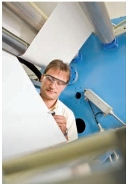
Keramik von der Rolle: Keramische Separatoren steigern die Sicherheit von Lithium-Ionen Akkus (© Evonik)
