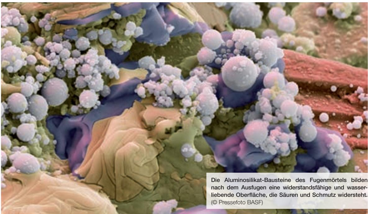
Die Aluminosilikat-Bausteine des Fugenmörtels bilden nach dem Ausfugen eine widerstandsfähige und wasserliebende Oberfläche, die Säuren und Schmutz widersteht.
