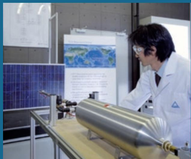
**Ein Mitarbeiter vom TÜV Rheinland prüft die Haltbarkeit von Photovoltaik-Modulen mit dem Hagelschlag-Test. Dabei werden genormte Hagelkörner mit einer genau festgelegten Geschwindigkeit auf die Module geschossen.**
