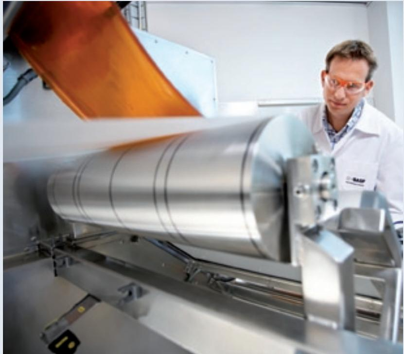
Ein Ingenieur überwacht das Aufwickeln einer Membran für Brennstoffzellen. Ist sie aufgerollt, wird sie in die Produktionsanlage gebracht und zur Membran-Elektroden-Einheiten, dem Herzstück einer Membran-Brennstoffzelle, verarbeitet.
