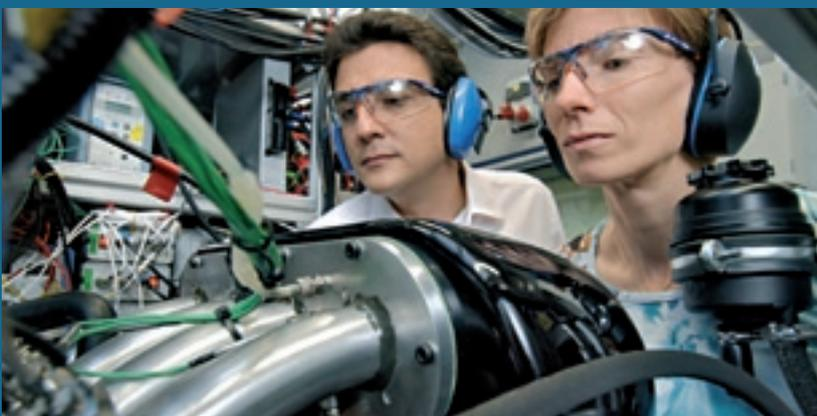
Verbrennungsforschung: Zwei Entwickler von Bosch testen neue Systeme für die Motorsteuerung. Mit kontrollierter Selbstzündung werden Kraftstoff und Luft gleichmäßig im gesamten Brennraum gemischt, verteilt und vollständig verbrannt.
