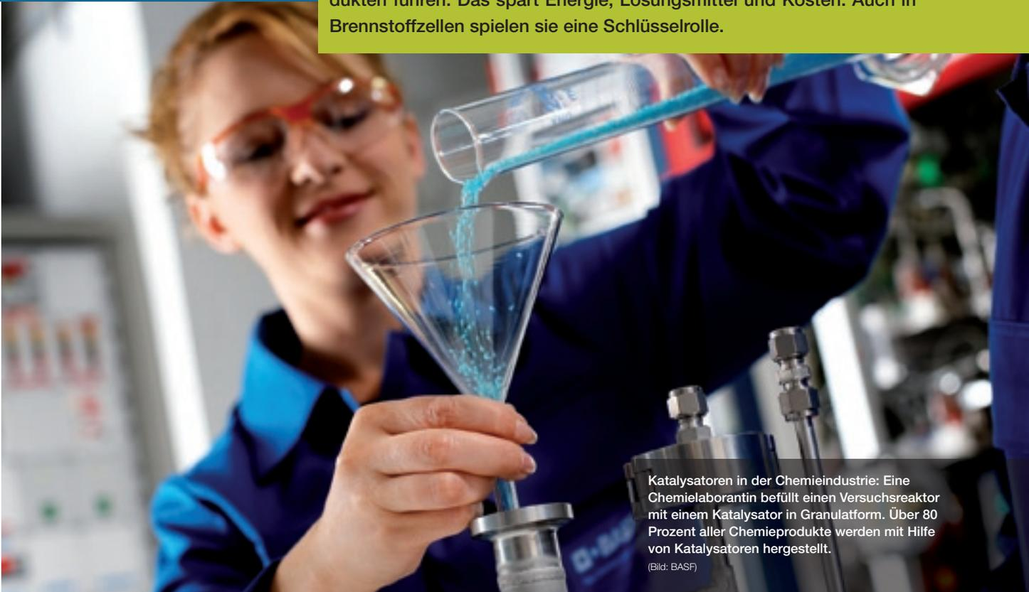
Katalysatoren in der Chemieindustrie: Eine Chemielaborantin befüllt einen Versuchsreaktor mit einem Katalysator in Granulatform. Über 80 Prozent aller Chemieprodukte werden mit Hilfe von Katalysatoren hergestellt.
