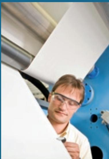
**Keramik von der Rolle: Der keramische Separator steigert die Sicherheit von Lithium-Ionen-Akkus.**
