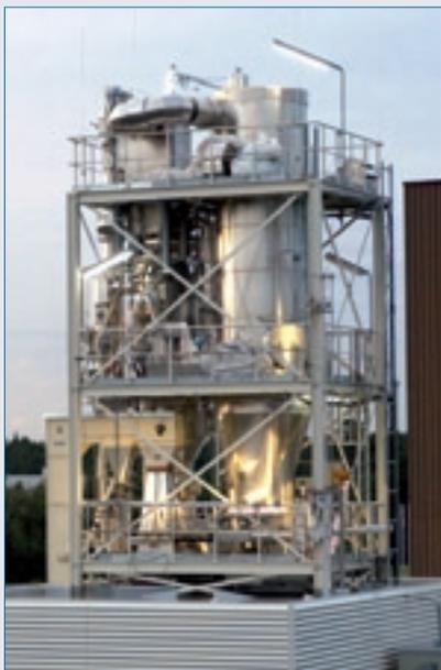
Teil einer Pilotanlage im Forschungszentrum Karlsruhe: Hier wird Biomasse durch Schnellpyrolyse zu einem Öl verflüssigt, aus dem anschließend Kraftstoffe hergestellt werden.
