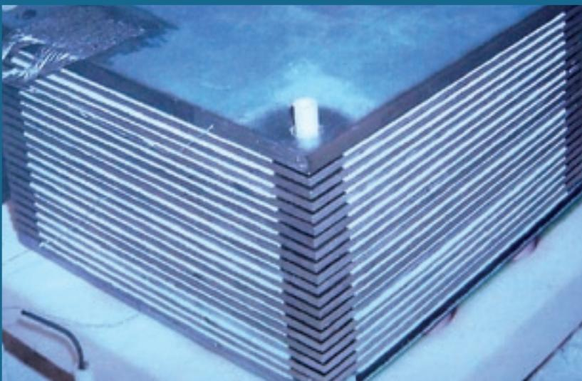
Zusammengesetztes Element aus zwanzig gestapelten elementaren Festoxid-Brennstoffzellen. So lassen sich höhere Spannungen erreichen.
