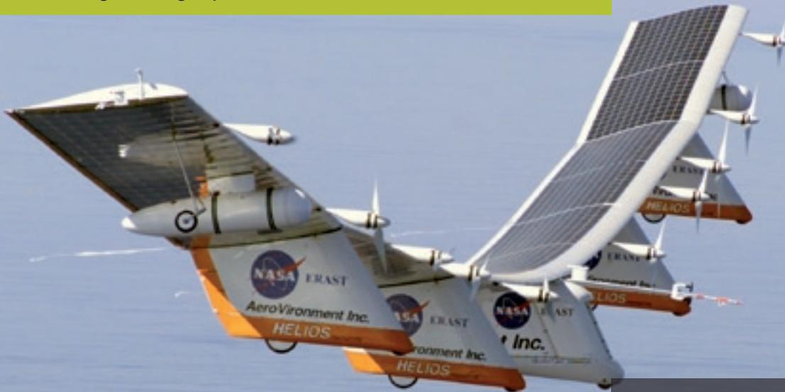
Das unbemannte Forschungsflugzeug Helios der Nasa: Tagsüber flog es mit Sonnenenergie, nachts wurde es mit Brennstoffzellen betrieben. Helios flog bis in eine Höhe von 30 Kilometern – bis es im Jahr 2003 über dem Pazifik zerbrach und abstürzte.
