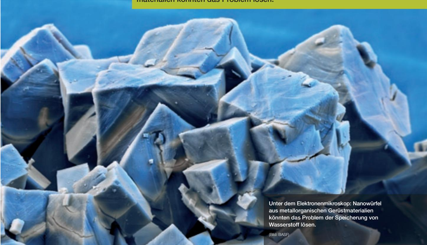
Unter dem Elektronenmikroskop: Nanowürfel aus metallorganischen Gerüstmaterialien könnten das Problem der Speicherung von Wasserstoff lösen.
