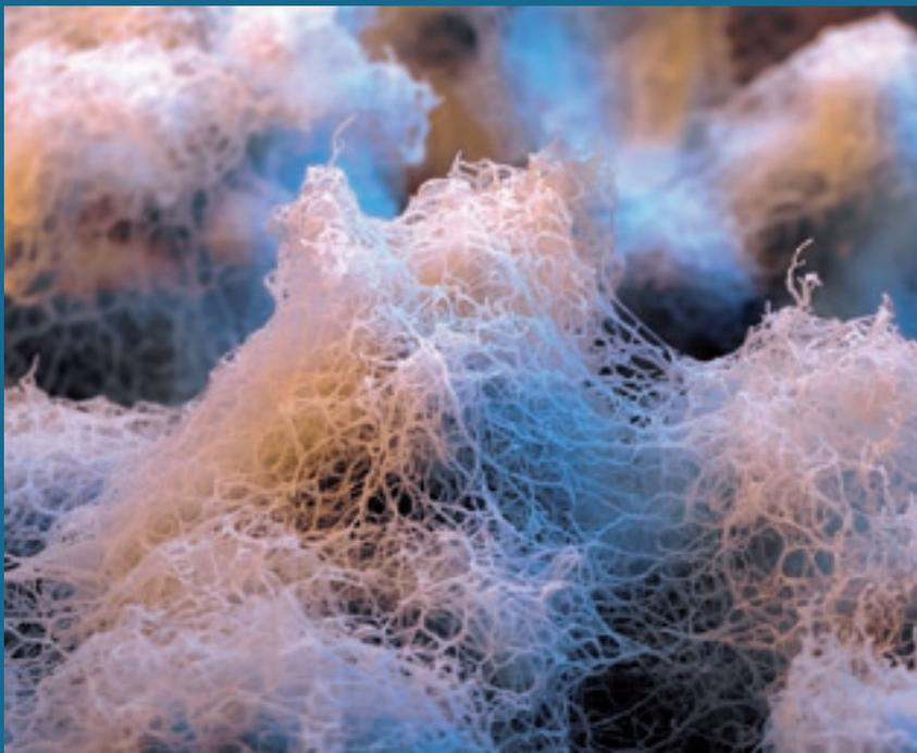
Ein nanoporöser Isolierschäum unter dem Rasterelektronenmikroskop: Bei neuen Schaumstoffen soll die Größe der Poren nicht mehr im Mikro-, sondern im Nanometerbereich liegen. Dadurch könnte die Dämmwirkung eines Schaumstoffs um mehr als 50 Prozent verbessert oder die benötigte Materialdicke für eine gegebene Dämmleistung um mehr als die Hälfte reduziert werden. (Bild: BASF)
