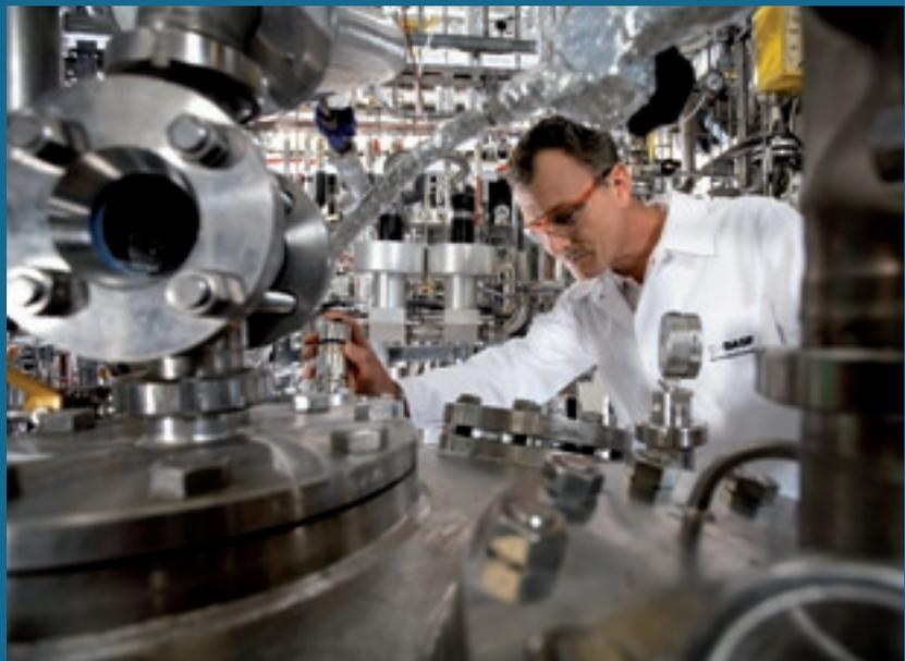
Biotechnik in der Chemieindustrie: Ein Biotechniker kontrolliert eine laufende Fermentation in einem 5000-Liter-Bioreaktor.
