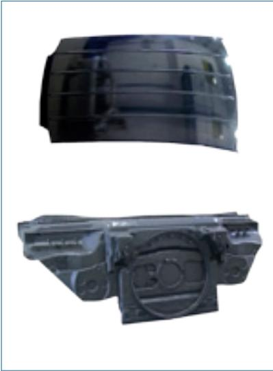
Mit Kohlenstofffasern verstärkter Verbundwerkstoff: Dach und Frontend für ein Auto.
