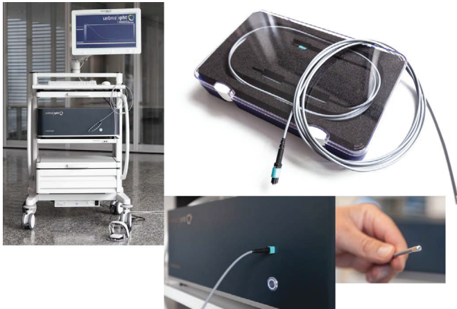
Abb. 2: Raman invaScope für den in-vivo -medizinische Einsatz: Entwicklung einer Plug-and-Play medizinischen Raman-Plattform für die klinische Diagnostik zur In-vivo -Erfassung von Raman-Spektren. Die zugehörige faseroptische Raman-Sonde kann in Kombination mit einem Endoskop mit Arbeitskanal verwendet werden. Weiter Anwendungsgebiete ergeben sich u.a. in der (i) Zellforschung (Krankheitsdiagnose, Wechselwirkungen zwischen Medikamenten und Zellen); (ii) Raman-basierte Assays; (iii) Pharmazeutische Anwendungen wie Prozessanalytik.
