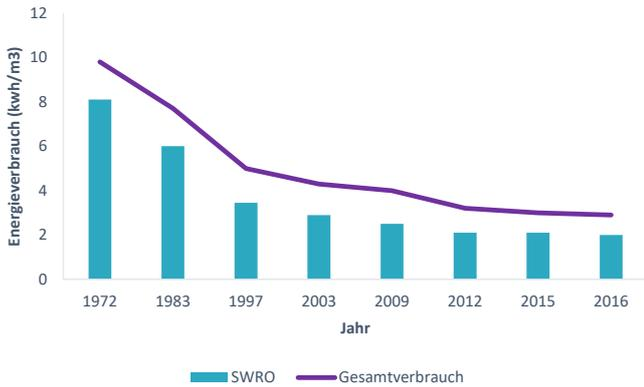
Abb. 3: Energieverbrauch der Meerwasser-Umkehrosiose über die Jahre, nach [7].
