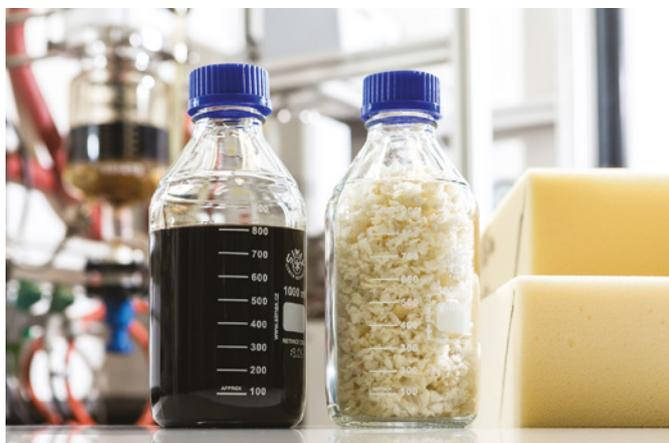
**Abb. 1:** Im innovativen Recyclingverfahren von BASF für gebrauchte Matratzen wird flexibles Polyurethan (r) aufgespalten und liefert das ursprünglich verwendete Polyol (l).
