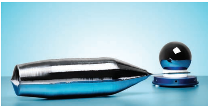
Abb. 5: Silicium-Einkristall aus hochangereichertem ^{28}\text{Si} und eine 1 kg Silicium-Kugel (Durchmesser ca. 93,7 mm).
