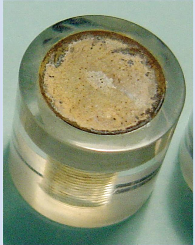
**Abb. B6: Spaltkorrosion an einem Modellzahn aus Plexiglas mit einer Amalgamfüllung. Die im Spalt zwischen Füllung und Kunststoffkörper bevorzugt stattfindende Korrosion wird durch verstärkte Ablagerung am Rand des sichtbaren Teils der Füllung sichtbar.**
