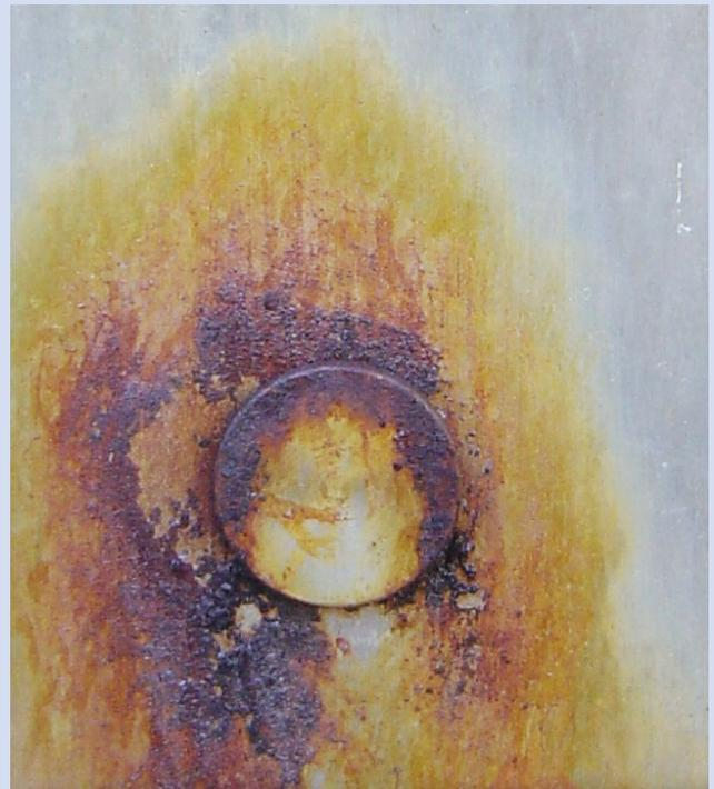
**Abb. B2: Schaden durch Kontaktkorrosion**
