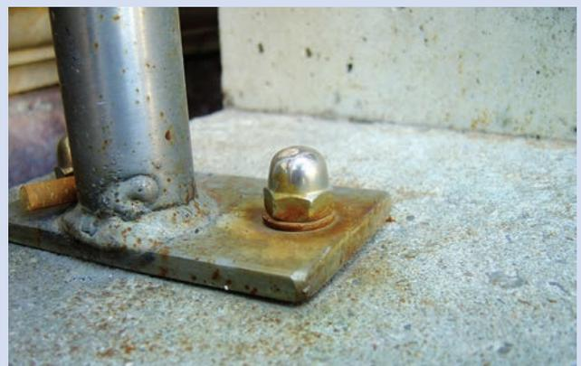
**Abb. B4: Kontaktkorrosion gefördert durch ungeeignete Montage**
